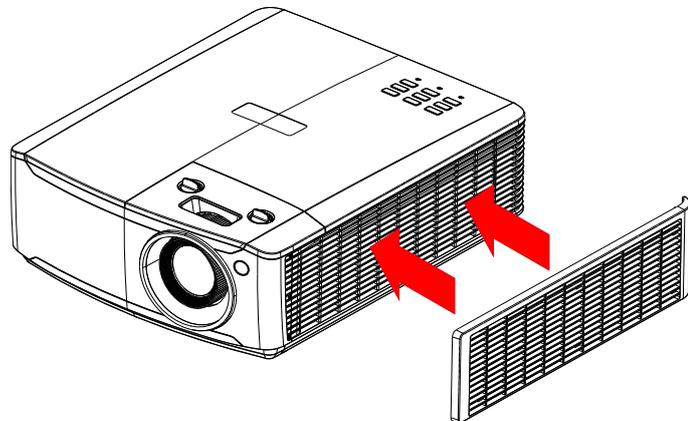
4. Ligue o projector e reponha o Contador do filtro de ar após a substituição do Filtro de ar.
