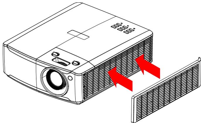
4. Accendere il proiettore e ripristinare il Timer filtro dell'aria dopo avere sostituito il filtro dell'aria.
