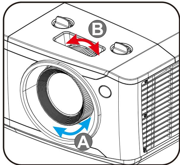
2. Usare il controllo di messa a fuoco **Image-focus** (solo sul proiettore) per rendere più nitida l'immagine proiettata. **A**
