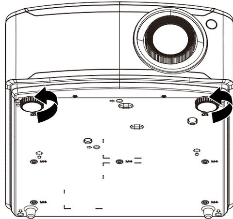
2. Heben Sie den Projektor zum Absenken der Projektorhöhe an und drehen Sie den Regler im Uhrzeigersinn.
