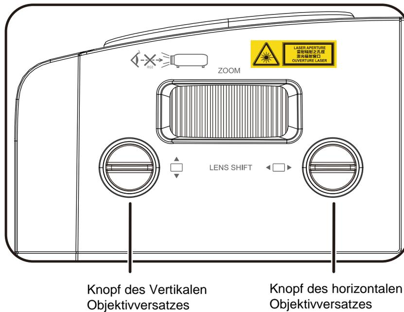
Die Versatzfunktion ermöglicht einen Objektivversatz, der der Anpassung der vertikalen oder horizontalen Position des projizierten Bildes innerhalb des nachstehend angegebenen Bereichs dient.
