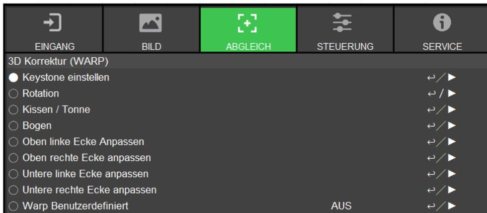
**Keystone einstellen:** Korrigieren Sie mit ▲ / ▼ horizontale Verzerrung und mit ▲ / ▼ vertikale Verzerrung.
