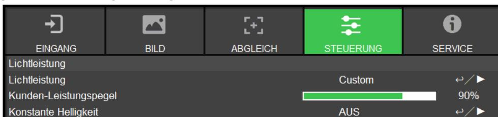
**Lichtleistung:** Wählen Sie mit ◀ / ▶ zwischen energiesparender, normaler und angepasster Leistungsstufe.
