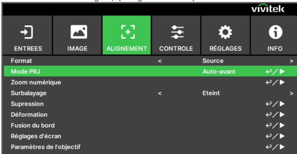
Utilisez le bouton ◀ ou ▶ pour sélectionner un mode de projection afin d'inverser l'image projetée selon l'orientation de l'installation ou le sens de visualisation. Les options de sélection sont décrites ci-dessous.
