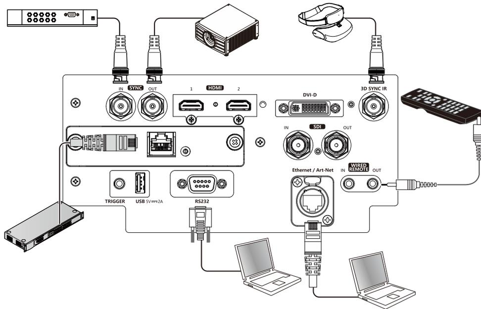
**HDBaseT / LAN (contrôle réseau) :** Le projecteur prend en charge le contrôle par réseau. Le LAN et HDBaseT partagent le même port. Si seul le contrôle par réseau est utilisé, vous pouvez raccorder le LAN sur le projecteur à un PC ou via le réseau local. Reportez-vous au manuel de contrôle à distance pour des informations détaillées.
