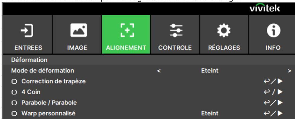
**Mode de déformation :** 4 modes peuvent être sélectionnés : Correction de trapèze, 4 Coins, Coussinet/Barillet et Déformation personnalisée.
