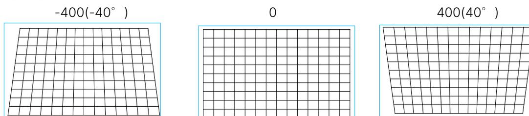
En plus de corriger le trapèze H et V de façon dissociée, vous pouvez utiliser la combinaison de trapèze H et V pour corriger la déformation. Dans ce cas, la plage efficace peut être limitée.
