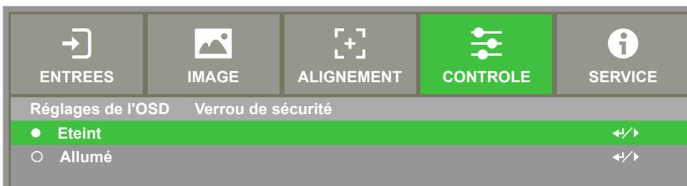
Une fois l'option Arrêt sélectionnée, la fenêtre contextuelle s'affiche pour confirmer le réglage. Sélectionnez OK pour désactiver la fonction, sinon sélectionnez Annuler pour ignorer le paramètre.
