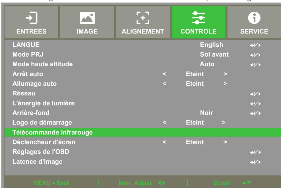
La boîte de message s'affichera comme suit lorsque vous entrez dans la télécommande infrarouge. Sélectionnez "ON" pour activer le contrôle ID ou "Off" pour annuler l'utilisation du paramètre ID.
