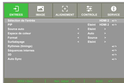
2. Appuyez sur ▲ ou ▼ pour sélectionner les éléments de menu et sur ◀ ou ▶ pour modifier les valeurs des paramètres. Appuyez ↵ sur pour confirmer le nouveau réglage.
