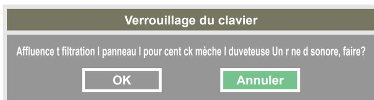
Une fois le verrouillage du clavier activé, tous les boutons de commande du projecteur sont verrouillés. Le message ci-dessous s'affiche sur l'écran quelques secondes si vous appuyez sur un des boutons de commande.
