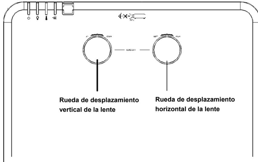
La función de desplazamiento permite desplazar la lente con el fin de ajustar la posición de la imagen proyectada a lo largo de los ejes horizontal o vertical dentro de los intervalos descritos a continuación.
