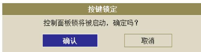
一旦激活按键锁定 ( Control Panel Lock )，投影机上的所有控制按钮即被锁定。如果按下任何的控制按钮，屏幕上将会显示下方信息数秒。
