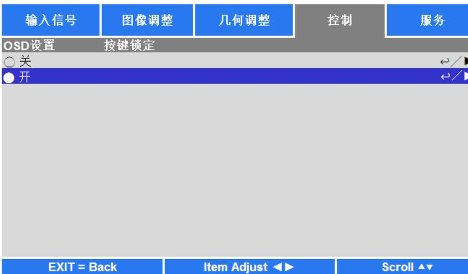
打开按键锁定 ( Control Panel Lock )，弹出信息会显示下图所示的锁定 ( Lock )，选择确认确定该设置或选择取消该设置。
