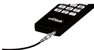
**Conector para el mando a distancia con cable** Permite conectar el terminal MANDO A DISTANCIA CON CABLE del proyector.
