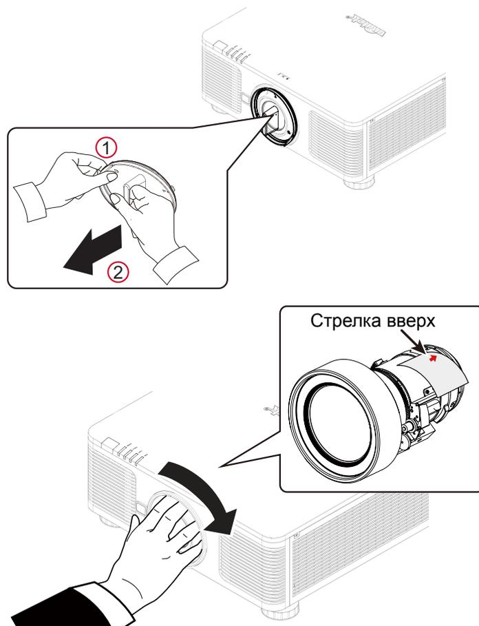
3. Убедитесь, что объектив правильно вставлен в держатель, поверните его по часовой стрелке в положение "Фиксация". При повороте объектива будут слышны два щелчка - объектив полностью зафиксирован.
