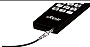
**Kabelfernbedienungsanschluss** Mit dem Anschluss WIRED REMOTE am Projektor verbinden.
