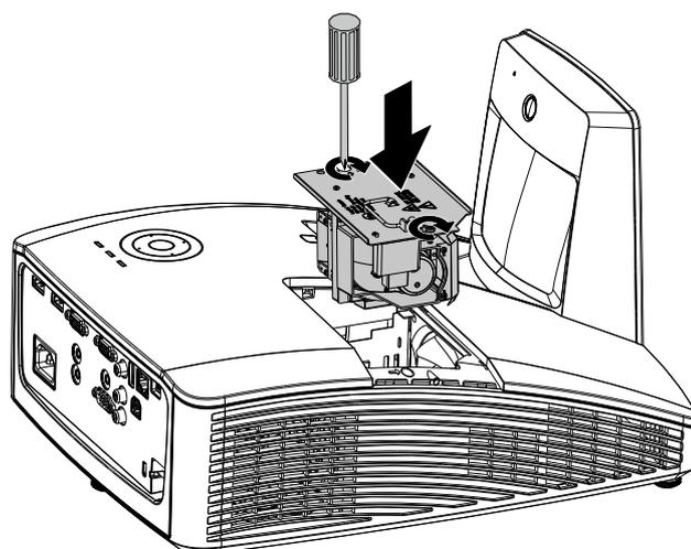
**Remarque :** Le module de la lampe doit bien être en place et le connecteur de la lampe doit bien être branché avant de resserrer les vis.
